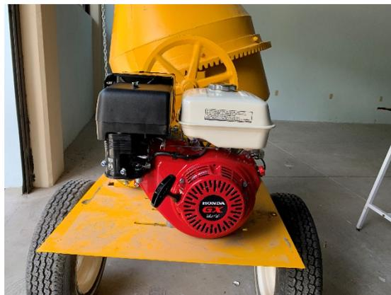
*Ilustración 24 Rehabilitación de revolvedora de cemento*
